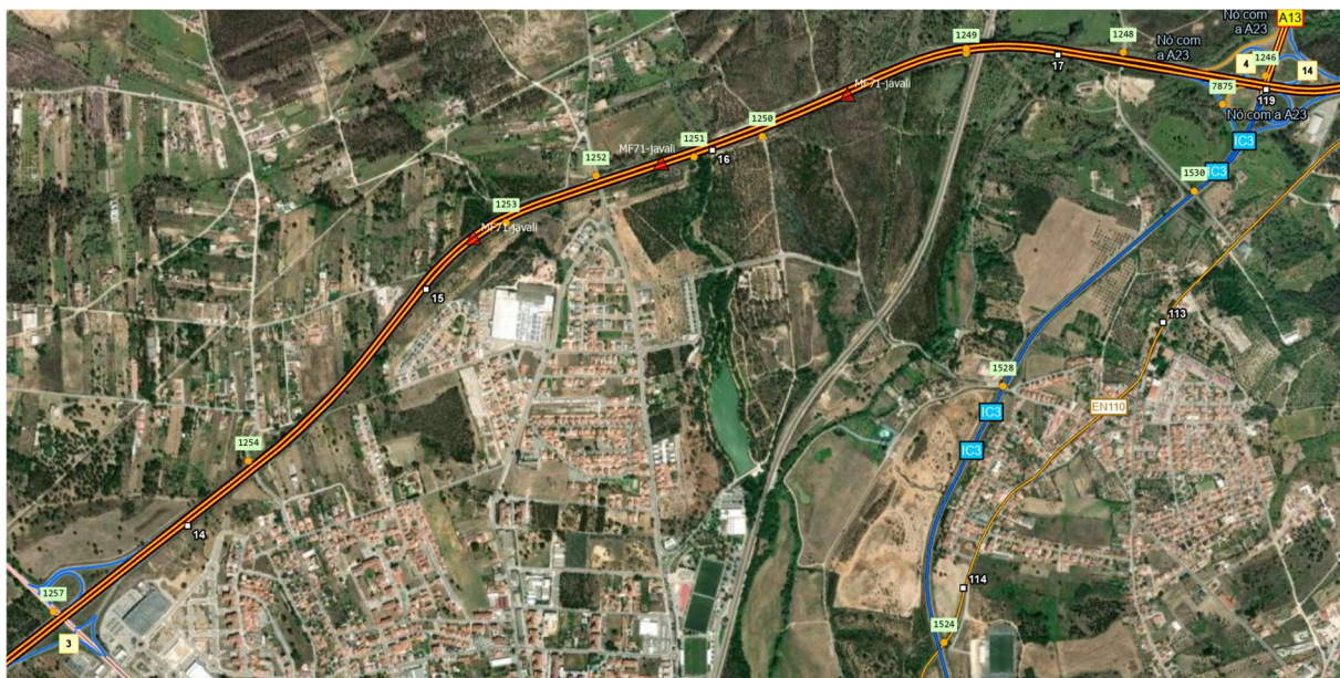
Fig. 17 – Troço da A23, entre os km 15,2 e 16,4 com três ocorrências de javalis atropelados (assinaladas com triângulos vermelhos) e representação das passagens existentes sob a estrada (pontos amarelos com referência ao número da obra de arte). Visualizam-se, igualmente, os nós nas proximidades deste segmento.
