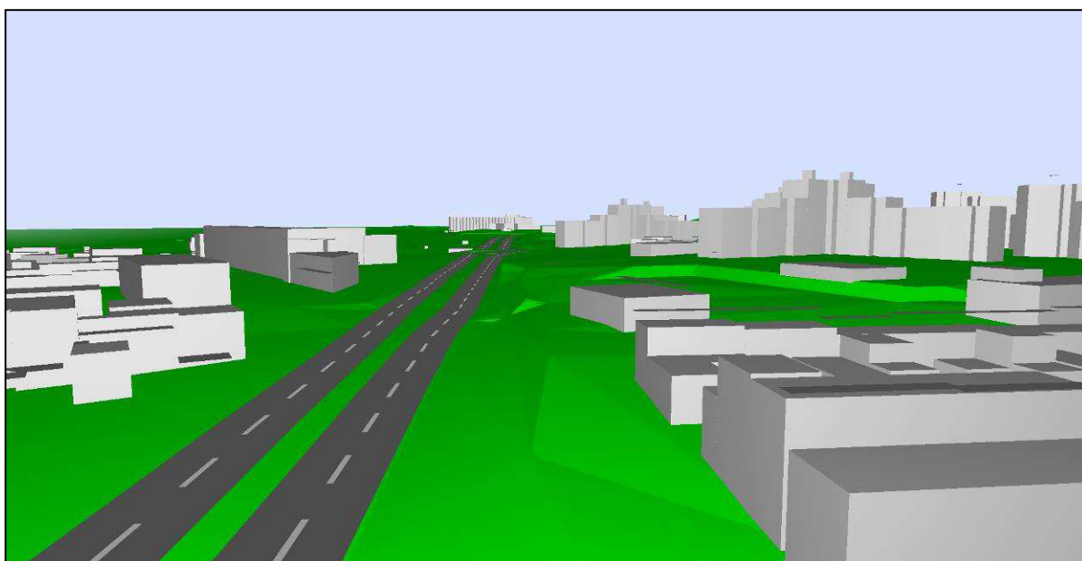
Figura 4-1 – Modelo digital do terreno construído com base nos elementos cartográficos, já com o troço da EN114 implantado
